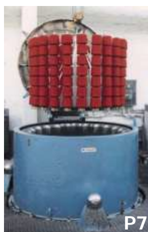
Гидроэкстрактор с держателем шпинделя для конических и цилиндрических бобин. Тип KBOB
