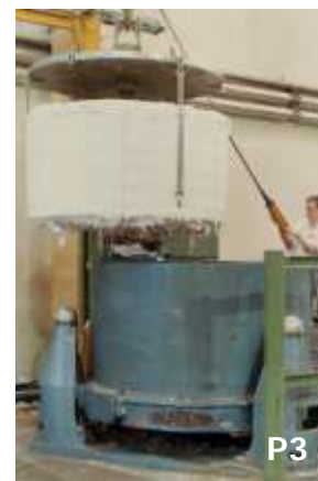
Гидроэкстрактор с торцевой пластиной и цепями для обезвоживания кека после окраски в автоклаве. Тип KGA
