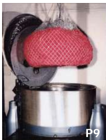
Гидроэкстрактор со съемной сеткой для мотков, тканей и лоскутков. Тип KFI
